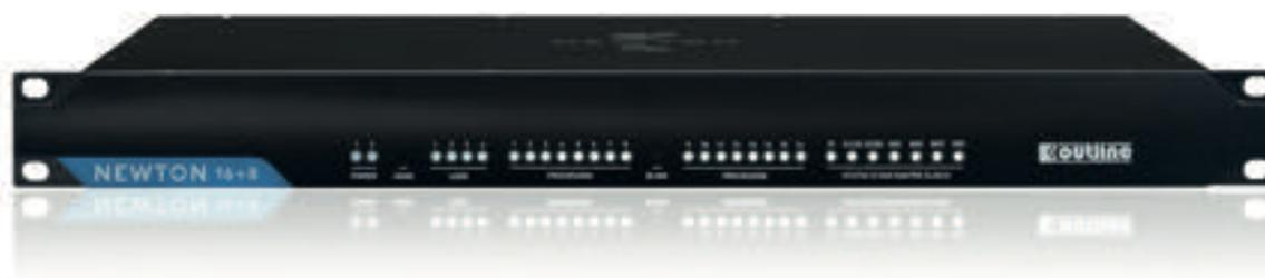
**O**utline afirma que este procesador será la «próxima generación» en gestión y control de audio digital. **Newton** (pendiente de patente) es una plataforma de procesamiento basada en FPGA, y diseñada para la gestión y el control de redes de audio en giras, broadcast e instalaciones fijas.
